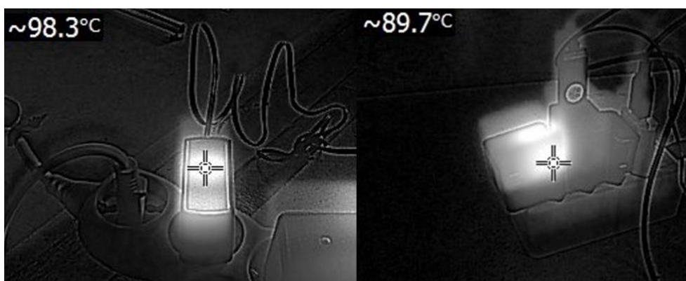
Figur 8: Temperaturmätning på en adapter och en USB-laddare under test
