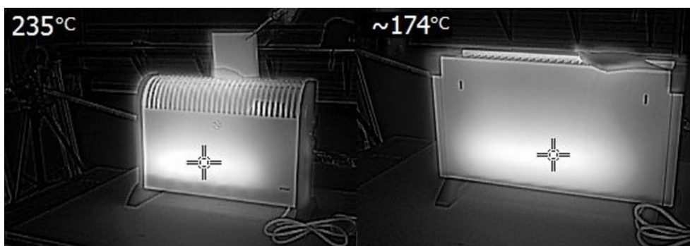
Figur 6: Temperaturmätning på två konvektorelement under test
