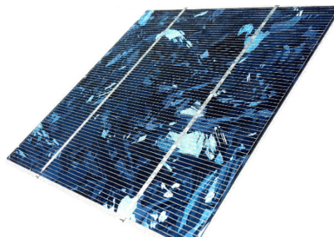
Figur 12: Solcell av poly-kristallint kisel
